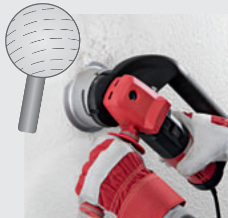
Behangpapier dat door een verlaag afgedicht is, wordt door de snijwielen van de nieuwe perforator geopend. Daardoor kan het vocht (afwekmiddel) sneller binnendringen.
