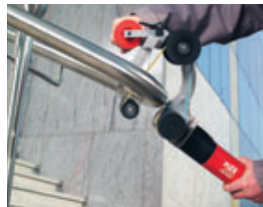
Bij het schuren en polijsten van buisrondingen kan snel en proper gewerkt worden.
