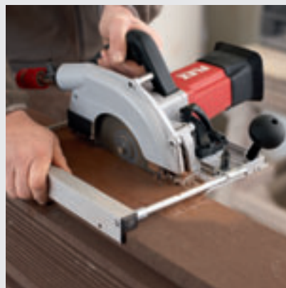
Met de meegeleverde parallelaanslag kan men ook zonder hulp van een geleidingsrail precieze zaagsneden maken.
