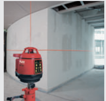
Het aanleggen van een meetlijn is met de roterende straalcirkel ook op gegolfde wandvlakken snel geregeld. Volautomatische rotatielaser ALR 512
