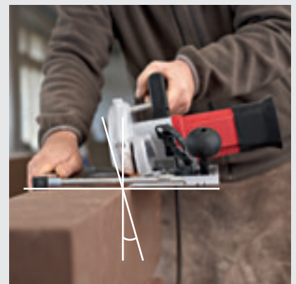
Door de preciese en wederzijds montagebare parallelaanslag, kan met de CS 60 WET ook een schuine snede gemaakt worden.
