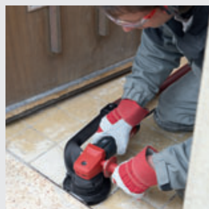
Het borstelsegment dat u zonder gereedschap kunt verschuiven, is ideaal om langs randen te werken.
