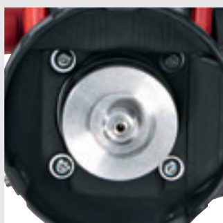
Dempelement tussen de as en het gebruikte werktuig vermindert trillingen en verhoogt de looprust. Tegelijk kunt u de machine beter geleiden en neemt de levensduur toe.
