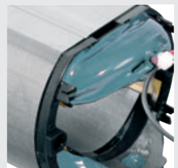
Wikkeling met epoxycoating aan het veldpakket
