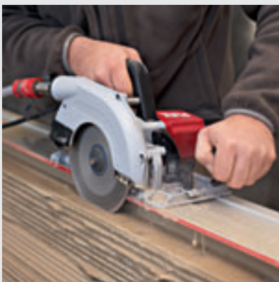
De CS 60 WET, in combinatie met de geleidingsrail, is uitermate geschikt voor het zagen van afwateringskanaaltjes in vensterbanken.
