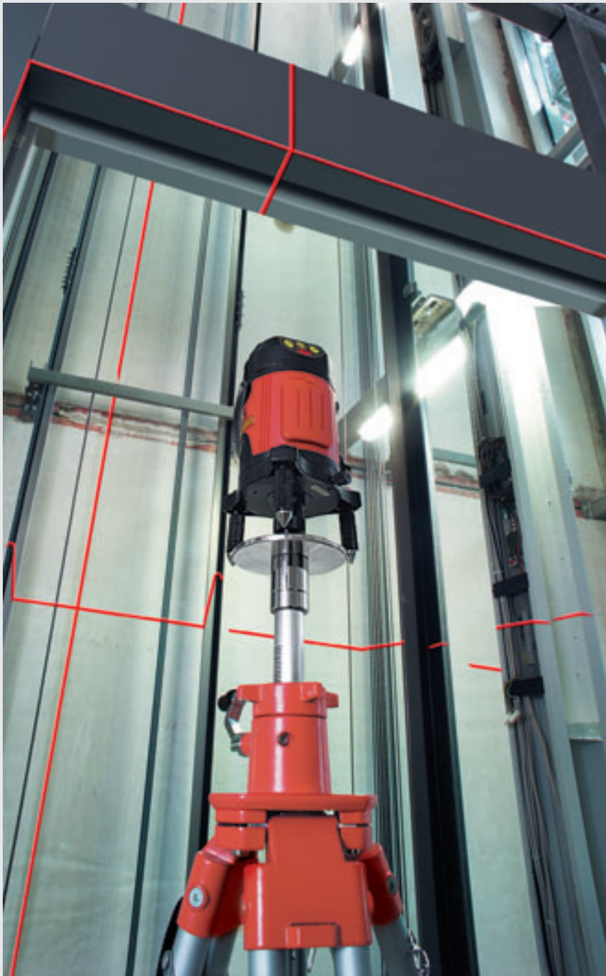
Met horizontale laserlijn en twee inschakelbare verticale lijnen laten ruimtelijke oppervlakken zich snel en makkelijk uitlijnen.
