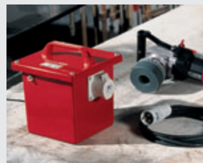
Bij vele FLEX nat-steenlijpmachines zit er standaard een contour-stekker op. Deze kan uitsluitend in een transformator worden gebruikt en niet in een stopcontact.
