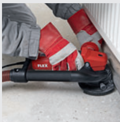
Ook met een geopend borstelsegment functioneert de stofafzuiging perfect.
