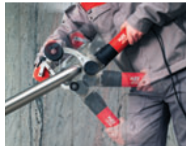
Complete bewerking van buizen zonder zichtbare naden met de Boa van FLEX.
