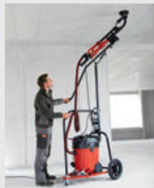
Aangezien er meer druk gezet moet worden bij het bewerking van betonnen muren en het plafond is er meestal een grotere hoeveelheid kracht nodig. De GM 320 vermindert deze inspanning aanzienlijk.
