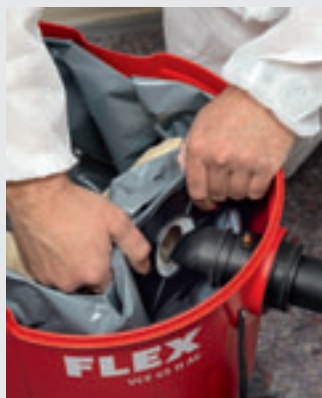
Perfekte opvang/verwijdering van het stof door de dubbelwandige veiligheidsstofzak.
