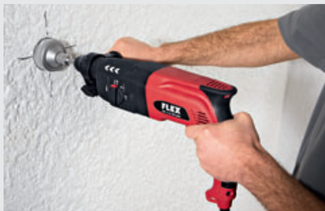
Dankzij het SDS-plus systeem gebeurt het verwisselen van boren en beitels bliksemsnel.
