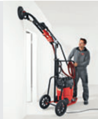
Om muuroppervlakken te kunnen bewerken kan de gereedschapshouder langs beide zijden 90° gedraaid worden.
