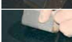
AKELUX Silikon-Schleifleinen über den Polierblock legen und Schadstelle nass feinschleifen.
